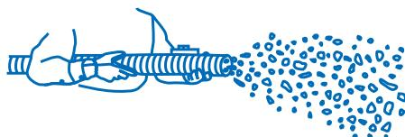
Sople el aislamiento hasta el espesor deseado.
