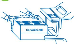
Coloque la mitad del paquete en la bandeja canal, alineando las flechas, y corte el paquete.
